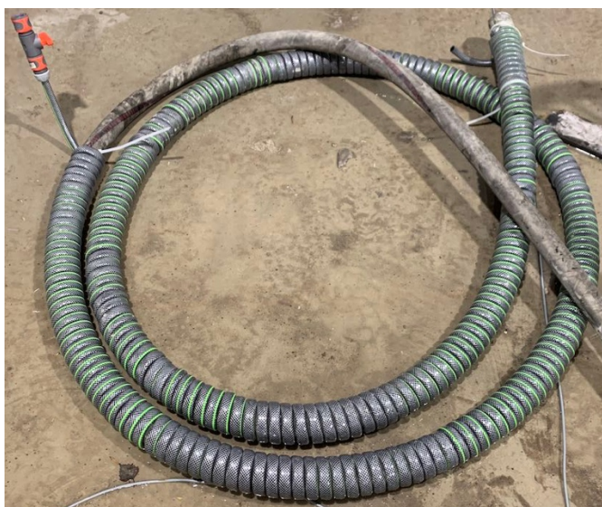
Figur 3.4 Exempel där en vattenslang har använts för att kyla slangen. Den kan naturligtvis användas för att värma slangen vid någon minusgrad.
