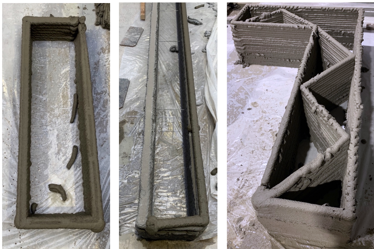
Figur 3.5 Väggtypkonstruktioner. a) enkel vägg. b) vägg förstärkt med metallpinne mellan inner och yttrevägg. c) zig-zag vägg – den förbindande zig-zag vägg ökar styrkan men påverkar den termiska konduktiviteten på ett negativt sätt.
