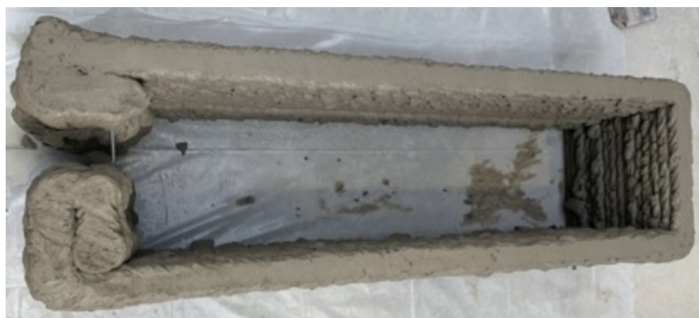
Figur 3.9 Projektet har fokuserat på att skapa en bruten köldbrygga som är flyttbar där man samtidigt skapar möjlighet för montagestöd för fönster och dörrar.
